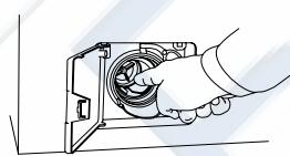
6. Навинтите крышку с фильтром, снова наденьте сливной шланг на патрубок в люке и закройте крышку люка.
